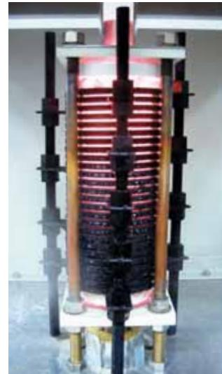
超高温過熱水蒸気発生装置
